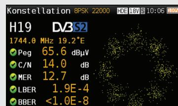
Konstellationsdiagramm bei einer DVB-S2 Messung
