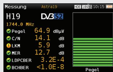
Kanalinformation mit Ampeldarstellung einer DVB-S2 Messung
